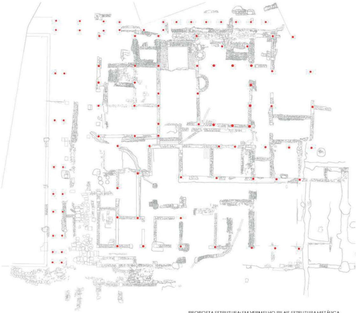
PROPOSTA ESTRUTURA: EM VERMELHO PILAS ESTRUTURAMETÁLICA.
